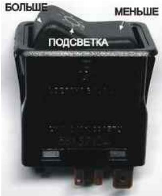
Контроллер имеет дружеское управление: при нажатии на любую клавишу - переключается в ручной режим и работает аналогично штатному переключателю вплоть до выключения зажигания. Нажатием и удержанием на 2 сек клавиши со стороны включения света ("БОЛЬШЕ" см. Рис.) контроллер переходит в автоматический режим «ГОРОД». Нажатием и удержанием на 2 сек клавиши со стороны включения света ("МЕНЬШЕ" см. Рис.) контроллер переходит в автоматический режим «ГРАССА».
